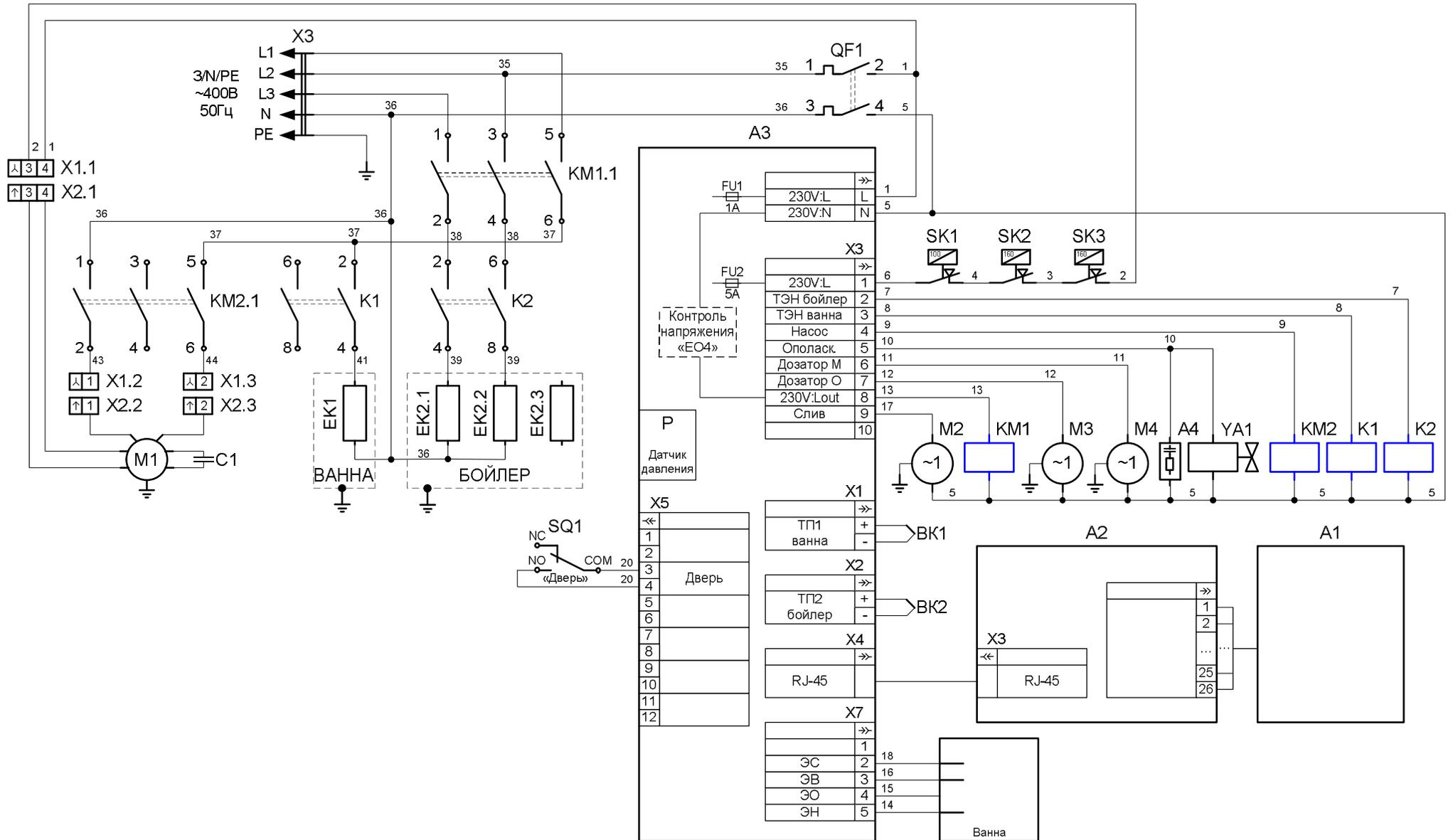
СХЕМА ЭЛЕКТРИЧЕСКАЯ СОЕДИНЕНИЙ МПК-500Ф, МПК-500Ф-01, МПК-500Ф-02
