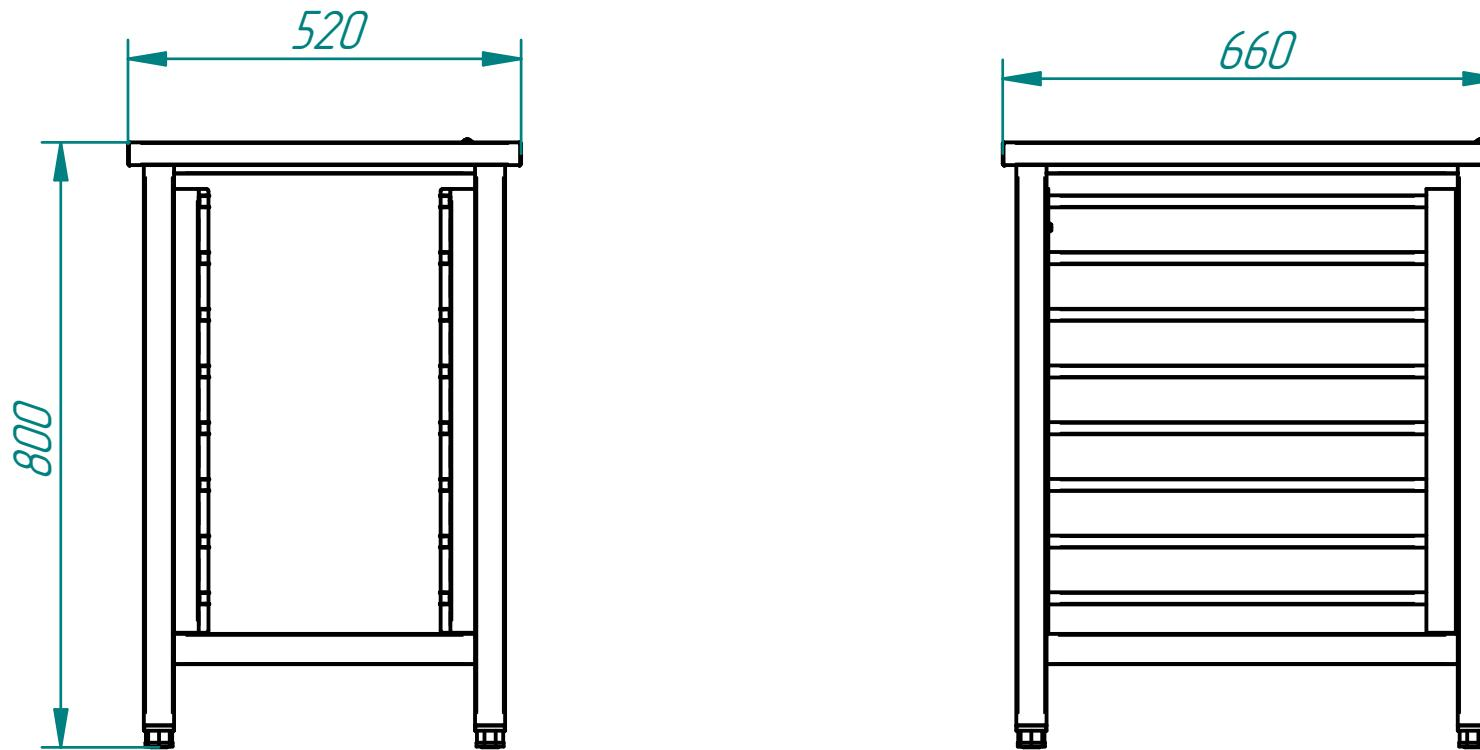
Подставка под конвекционные печи предназначена для использования на предприятиях общественного питания в качестве вспомогательного оборудования. На нее могут устанавливаться печи КПП-4-1/2П или КПП-4- 1/2Э. Подставка выполнена из высококачественной нержавеющей стали, что значительно продлевает срок ее службы. Также она оснащена регулируемыми по высоте ножками с резиновыми вставками.
