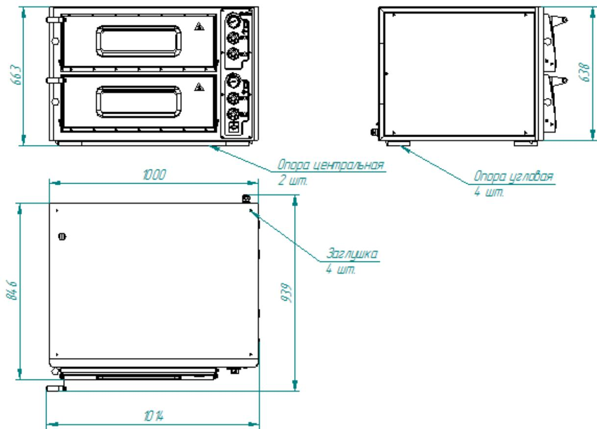
Рис.2 Общий вид печи ПЭП-4х2
