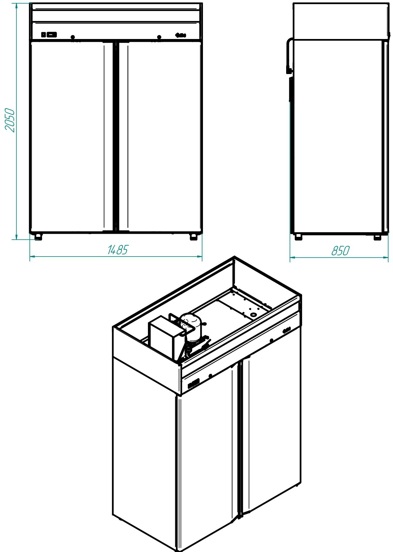
Шкаф холодильный типа ШХ-1,4 (ШХн-1,4;ШХс-1,4) с верхним расположением агрегата предназначен для хранения пищевых продуктов в охлаждённом или замороженном состоянии на предприятиях общественного питания и торговли.
