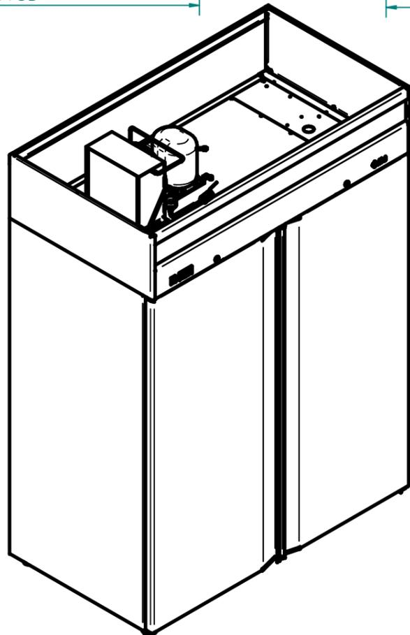
Шкаф холодильный типа ШХ-1,4 (ШХн-1,4;ШХс-1,4) с верхним расположением агрегата предназначен для хранения пищевых продуктов в охлаждённом или замороженном состоянии на предприятиях общественного питания и торговли.
