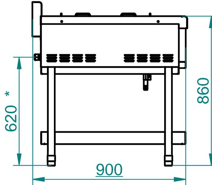
Электрический мармит кухонный типа ЭМК, предназначен для кратковременного сохранения в горячем состоянии вторых блюд в gastronorm-емкостях и раздачи их потребителю. Используется на предприятиях общественного питания самостоятельно или в составе технологических линий. Все элементы конструкции выполнены из качественной нержавеющей стали. Мармит имеет регулируемые по высоте ножки.
