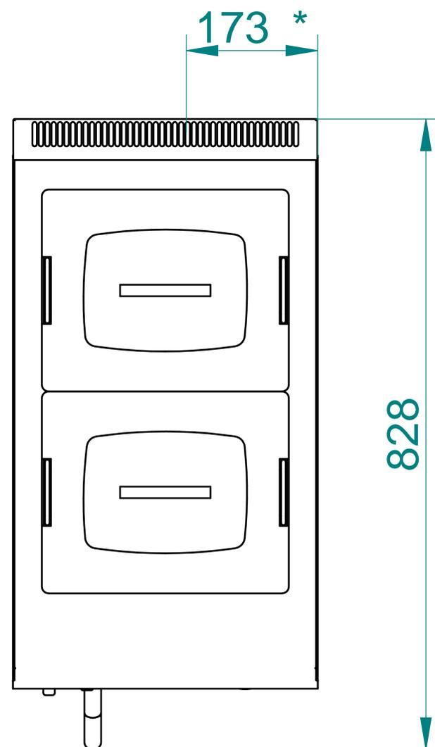
Электрический мармит кухонный типа ЭМК, предназначен для кратковременного сохранения в горячем состоянии вторых блюд в гостроемкостях и раздачи их потребителю. Используется на предприятиях общественного питания самостоятельно или в составе технологических линий.
