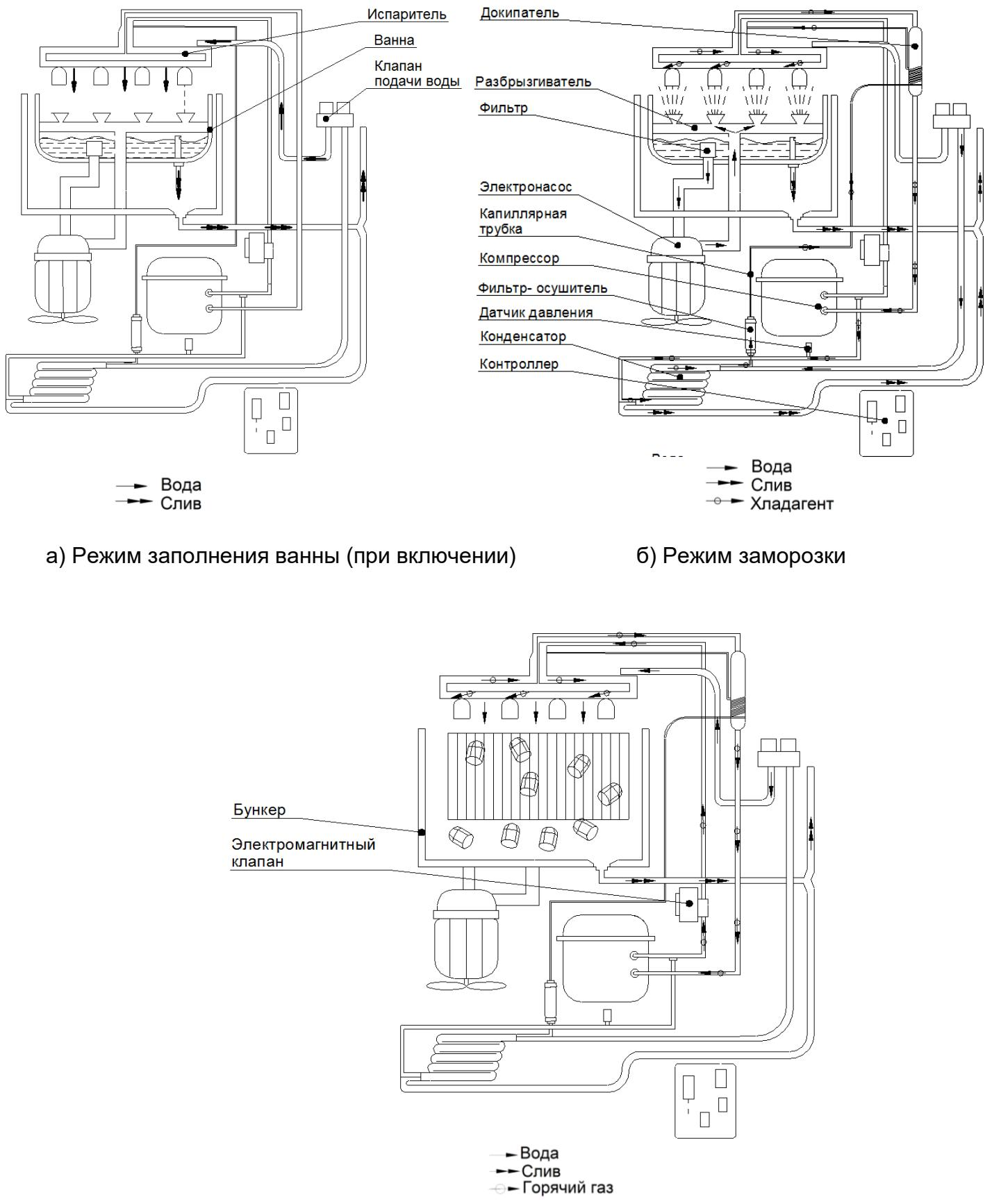
Рис. 5 Схема режимов работы льдогенераторов ЛГ-64/40К-01, ЛГ-80/40К-01
