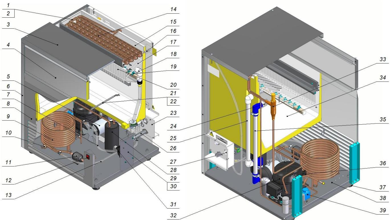
1 – Трубка датчика в испарителе
