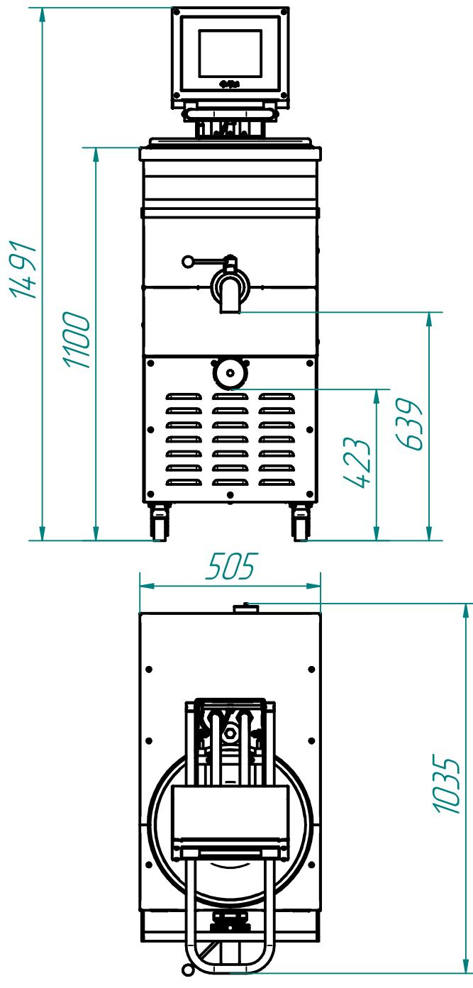
Ферментаторы типа ФТ предназначены для обеспечения необходимых режимов приготовления различных заквасок.
